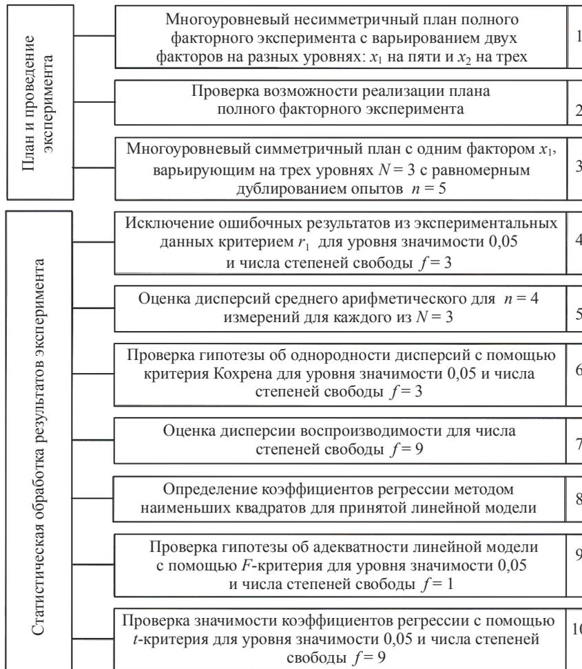
Рис. 2. Блок-схема проведения лабораторных экспериментов по исследованию тонких прослоев несвязных грунтов
